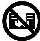
Das Symbol bedeutet, dass das Gerät nicht abgedeckt werden darf.
