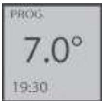
Nach Einstellung einer frostfreien Temperatur (7°C), zeigt der Bildschirm bei Wechsel in den Programmierbereich im ECO-Modus 6°.0 an (automatische Senkung um 1°C).
