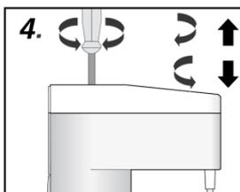
4. Die Ventildruckplatte mit einer Rechtsdrehung ein- oder mit einer Linksdrehung ausfahren.
