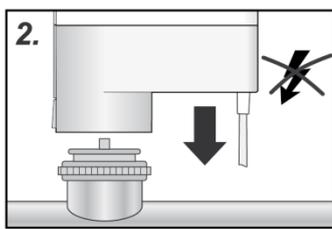
2. Den Stellantrieb im spannungsfreien Zustand per Hand senkrecht auf den Ventiladapter positionieren.
