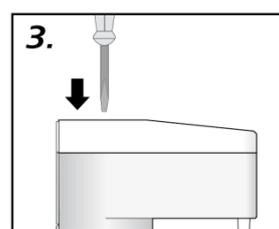
3. Einen Schraubendreher (0,3 x 2 mm) in die manuelle Ventilverstellung einführen.
