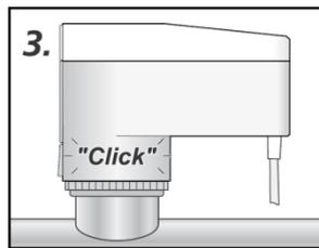
3. Durch senkrechten Druck per Hand den Stellantrieb problemlos und hörbar auf dem Ventiladapter einrasten lassen.
