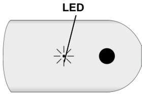
Für die Funktionssignalisierung von Betriebszuständen, verfügt der Motoric Valve Drive: 230 V 3-Point über eine mehrfarbige LED. Als Signalfarben werden Grün, Orange und Rot verwendet. Eine Signalisierung erfolgt nur, wenn der Stellantrieb mit Betriebsspannung versorgt wird.
