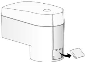
Der Motoric Valve Drive: 230 V 3-Point ist durch einfaches Entfernen der Verriegelungstaste vor Demontage durch Unbefugte gesichert.
