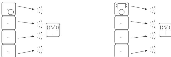
Master-Slave-Betrieb: (Komforttemperatur durch den Raumsender. Zeitlich gesteuerter ECO-Betrieb, ON/OFF-, Urlaubs- und Partyfunktion durch den mitangelernten Uhrensender)
