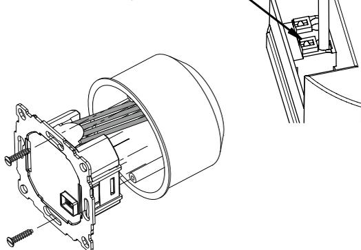
Die Drähte müssen so montiert werden, dass der Kunststoffstreifen als Isolation zur Befestigungsschraube wirkt.
