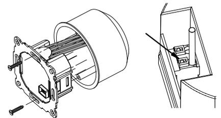
Die Drähte müssen so montiert werden, dass der Kunststoffstreifen als Isolation zur Befestigungsschraube wirkt.
